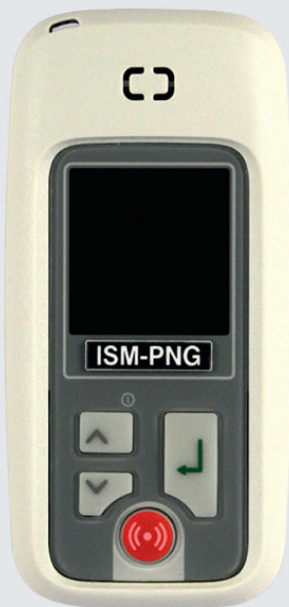
Der tragbare Rufempfänger mit Alarmfunktionen
